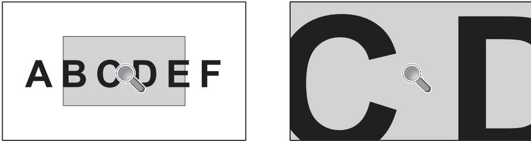
[POINT ZOOM] (點縮放) 功能可增大圖像尺寸，同時將其水平和垂直放大。圖像尺寸可以增大高達10倍。
