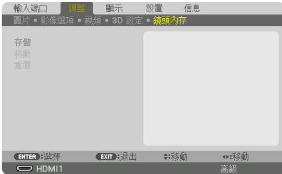
此功能用於在使用投影機的 鏡頭移動、縮放和 FOCUS 按鈕時存儲各輸入信號的調整值。調整值可套用至所選信號。這樣在選擇信號源時無需調整鏡頭位移、對焦及變焦。
